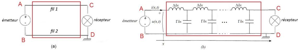
FIGURE 5 – Deux modèles de câbles coaxiaux : (a) modèle ARQS et (b) modèle non résistif, d'inductance linéique  $\Lambda$  et de capacité linéique  $\Gamma$ .
