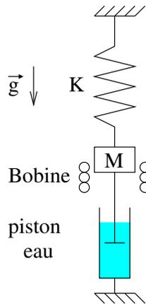
FIGURE 1 – Vue en coupe d'un oscillateur mécanique constitué d'un ressort de raideur  $K$  et d'une masse aimantée  $M$ . Un piston plongé dans l'eau est accroché à la masse qui se déplace à l'intérieur d'une bobine.
