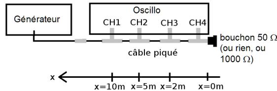
FIGURE 10 – Montage avec un câble piqué.
