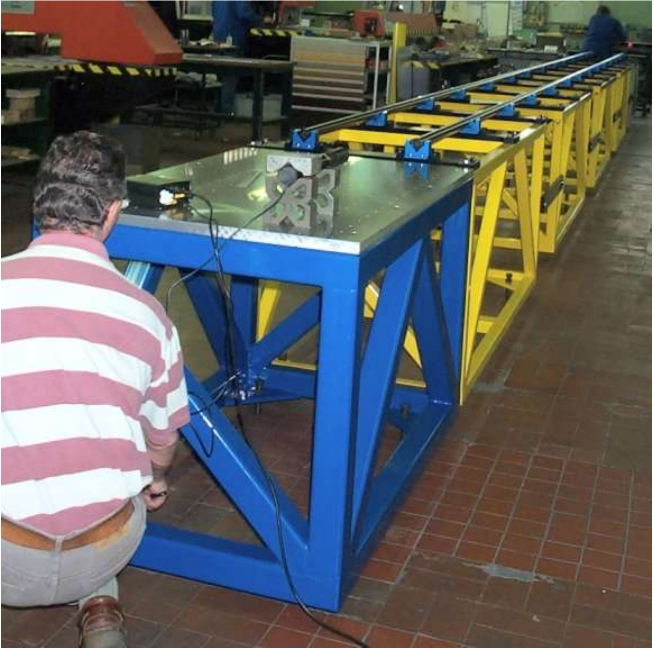
Illustration 14 : La ligne à retard en cours de fabrication à la DT/INSU, vérification de l'alignement. Photo DT/INSU.
