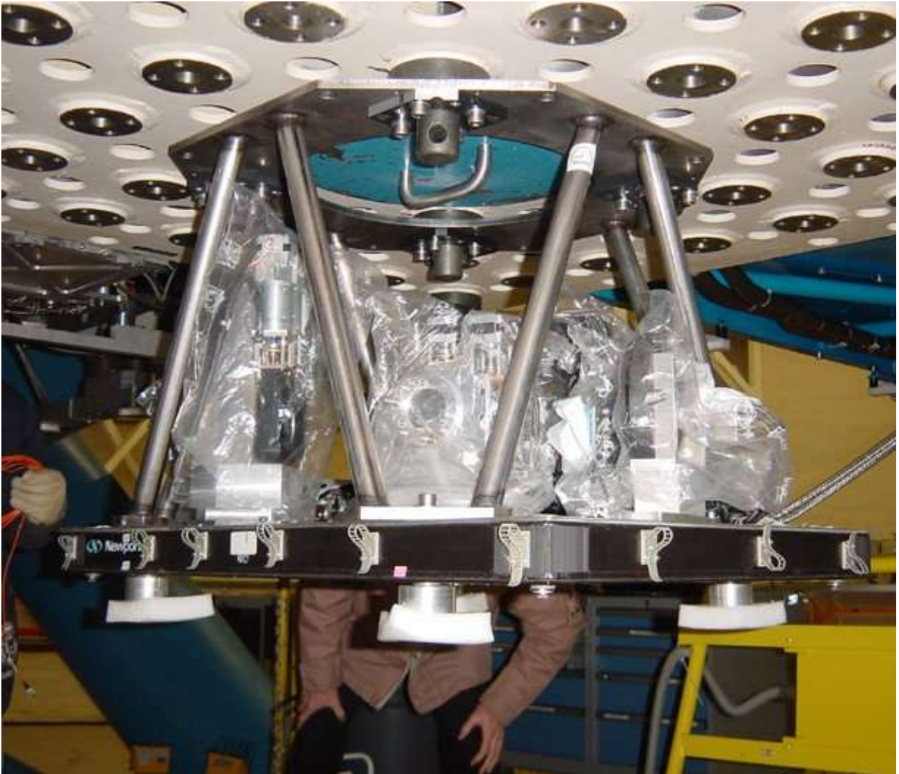
Illustration 17 : Test de montage de la platine d'injection sur l'ISS (Instrument Support Structure) du télescope Gemini, à Hawaï. Photo Observatoire.
