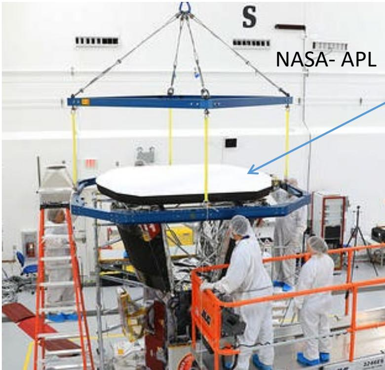
Bouclier thermique : 11 cm d'épaisseur , 2 couches de composite de carbone entourant une couche de mousse
