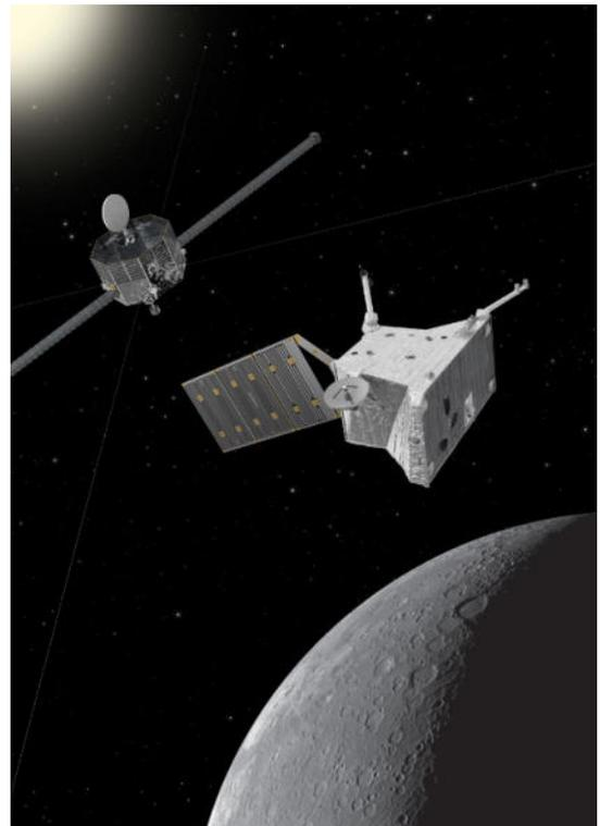
L'une des sondes, MPO, est fabriquée par l'ESA, qui est également chargée du module de transfert (pourvu de grands panneaux solaires et de quatre moteurs à propulsion ionique, pour effectuer le voyage de la Terre à Mercure) et du bouclier thermique de l'autre sonde, MMO, fabriquée quant à elle par l'agence japonaise JAXA.
