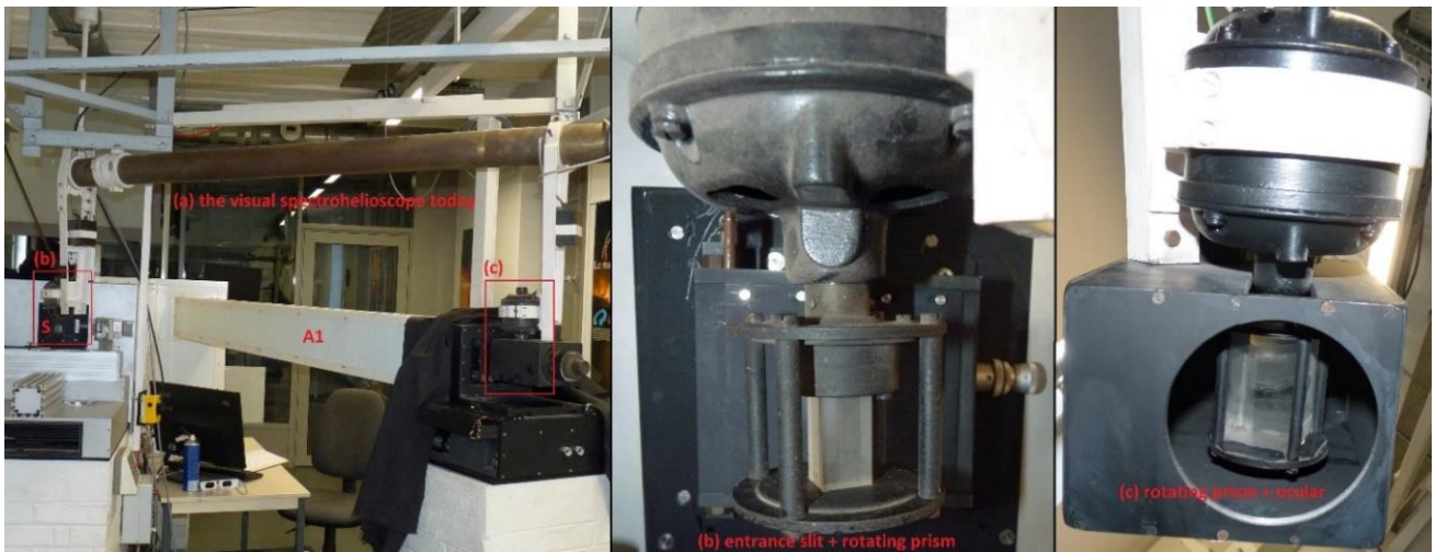
Figure 39. A gauche (a) : Le spectrohéloscope visuel fonctionnait avec deux prismes tournant à grande vitesse, respectivement devant la fente d'entrée (rectangle b) et derrière la fente de sortie dans le spectre (rectangle c). Deux moteurs synchrones remplacent le moteur unique de la Figure 38, de sorte que la mécanique complexe d'entraînement a été supprimée. Au centre (b) : le prisme (section carrée de 14 mm) dans le plan de l'image (moteur au-dessus). A droite (c) : prisme (section carrée de 32 mm) dans le spectre entre la fente de sortie et l'oculaire (moteur au-dessus). Le rapport des sections (32/14) correspond au grossissement du spectrographe (2.31). Crédit observatoire de Paris.
