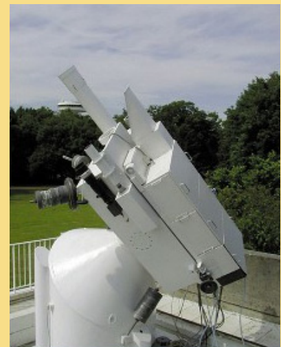
La monture équatoriale de l'héliographe de Meudon supporte plusieurs lunettes. © Observatoire de Paris
