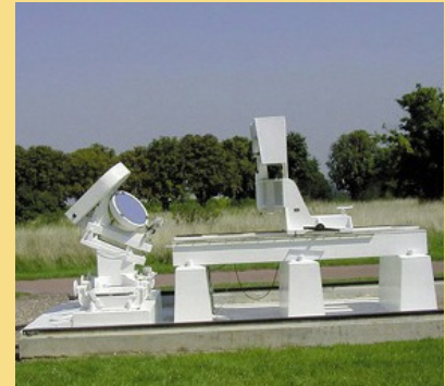
Le coélostat de Meudon dirige le faisceau de lumière solaire vers le laboratoire où il est analysé par le spectrohéliographe. © Observatoire de Paris
