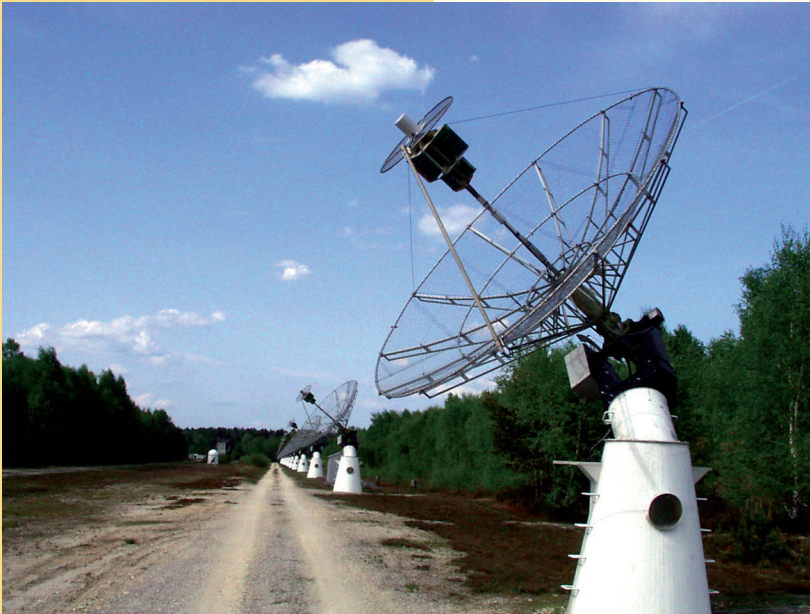
Le radiohéliographe de Nançay, où la station analyse les ondes métriques du Soleil. © Observatoire de Paris
