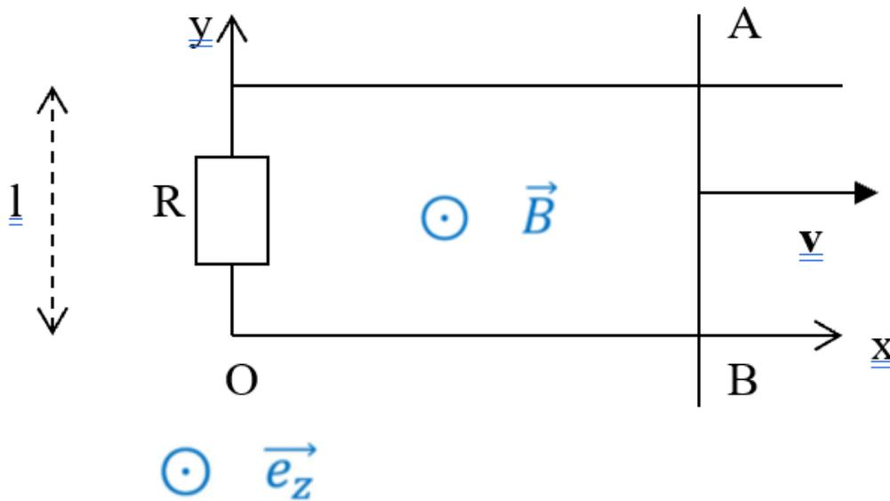
On considère un circuit fermé de résistance globale  $R$  constitué de rails conducteurs. Sur ces rails, un barreau conducteur  $AB$  est lancé en  $t = 0$  à la vitesse initiale  $\mathbf{v}_0$ , et glisse sans frottement dans le sens positif de l'axe  $Ox$ .
