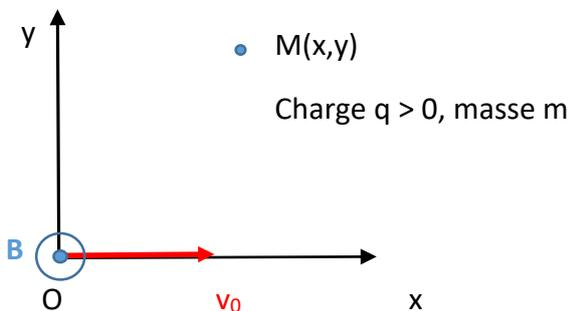
Une particule de charge  $q > 0$  et de masse  $m$ , initialement au point O et de vitesse  $v_0$  selon  $\mathbf{e}_x$ , est déviée par le champ magnétique  $\mathbf{B}$  dirigé selon  $\mathbf{e}_z$  (vecteur unitaire orthogonal au plan de la figure tel que  $\mathbf{e}_x, \mathbf{e}_y, \mathbf{e}_z$  forment un trièdre direct). A l'instant  $t$ , la particule est en M de coordonnées  $(x, y, z)$ .
