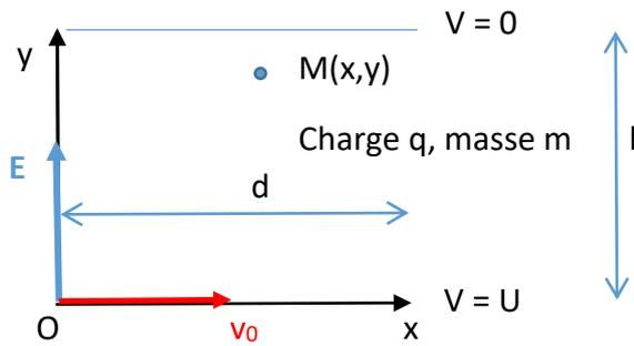
Une particule de charge  $q$  et de masse  $m$ , initialement au point O et de vitesse  $v_0$  selon  $\mathbf{e}_x$ , est accélérée et déviée par le champ électrique  $\mathbf{E}$  dirigé selon  $\mathbf{e}_y$ . A l'instant  $t$ , la particule est en M de coordonnées  $(x, y)$ .
