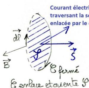
Courant électrique d'intensité I traversant la section S hachurée et enlacée par le contour C
