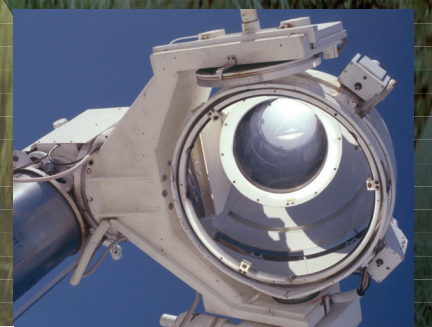
Dispositif à miroirs de captation de la lumière utilisé dans les tours d'observation solaire. © OBSERVATOIRE DE PARIS
