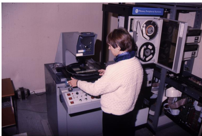
Figure 16 : Le CDCA, centre pilote dans les années 70, son microdensitomètre PDS 1010 et son PDP 11/40 avec bande magnétique et disques à droite (document OCA)
