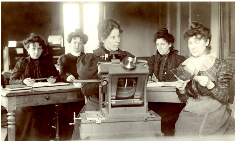
Figure 19 : Le bureau des mesures de la Carte du Ciel à l'Observatoire de Paris vers 1900, et la machine à mesurer les positions des étoiles (documents OP)
