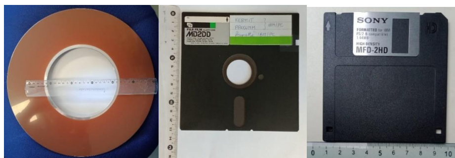
Figure 59 : Stockage des ordinateurs : disques amovibles du début des années 80. A gauche : disque 14 pouces de 10 Mo pour PDP 11. Au milieu : disquette IBM PC de 360 Ko en 5 pouces ¼. A droite : disquette IBM PC de 1.44 Mo en 3 pouces ½.
