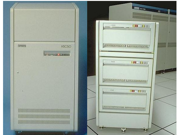
Figure 34 : Cabinet principal du VAX 8600, contrôleur HSC 50 et baie de 3 disques RA 81 (3 x 456 Mo), document DIGITAL
