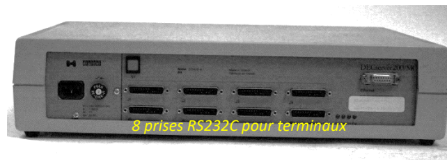
Figure 47 : Un serveur de terminaux « DecServer » 100 de Digital à 8 prises série RS232C. L'appareil était connecté au coaxial Ethernet épais via un câble AUI et une prise vampire H4000.
