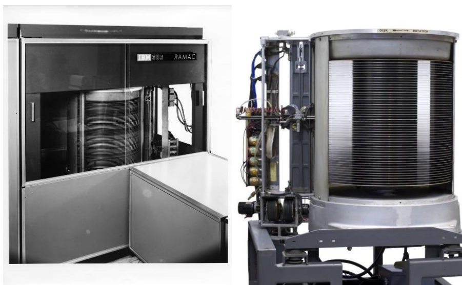
Figure 4 : Premier disque de 5 Mo pour IBM 650 RAMAC avec son bras et têtes de lecture/écriture à droite
