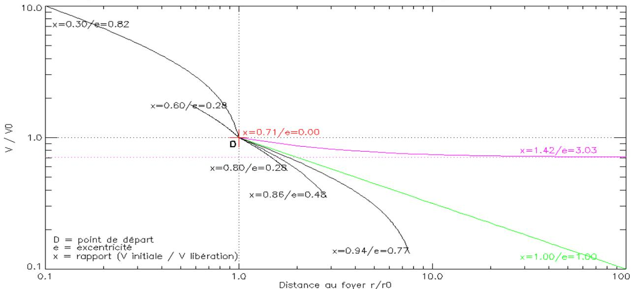
Vitesse  $v/v_0$  en fonction de la distance  $r/r_0$  au foyer F. D point de départ;  $v_0$  vitesse initiale.
