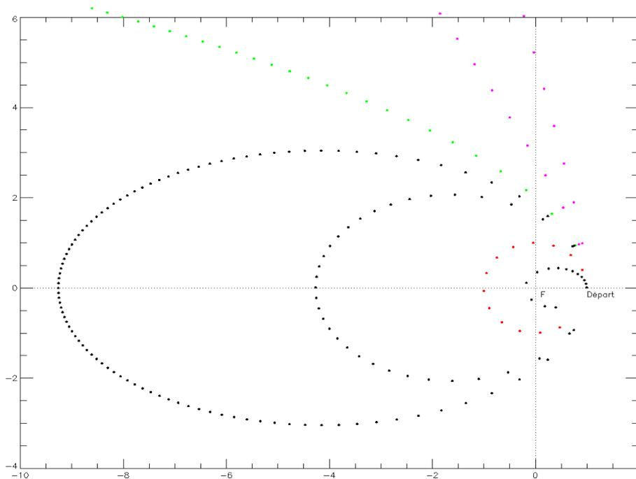
Cinématique des positions d'un objet de masse réduite  $\mu = m_1 m_2 / (m_1 + m_2)$  autour du centre de gravité ou foyer F. La vitesse initiale  $v_0$  au point de départ D est supposée orthoradiale (donc orthogonale à **FD**). Entre deux positions successives (représentées par les points), l'intervalle de temps est constant. Plus les points sont proches, et plus la vitesse est faible. Avec  $x = v_0/v_L$ ,
