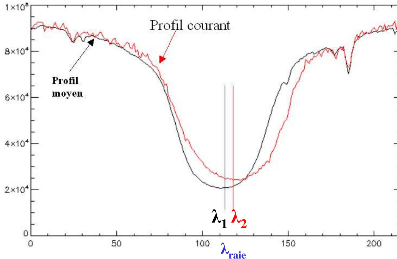
La vitesse radiale s'obtient à partir du décalage Doppler entre le profil moyen non perturbé (soleil calme) et le profil étudié, **mesuré par la position du minimum (ou mieux du centre de gravité).**
