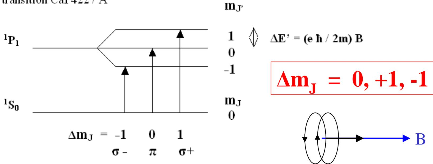
La transition  $\Delta m_J = 0$  est dite **composante  $\pi$**  ; elle est polarisée **linéairement dans la direction du champ magnétique** (direction de polarisation = direction du champ électrique de l'onde).
