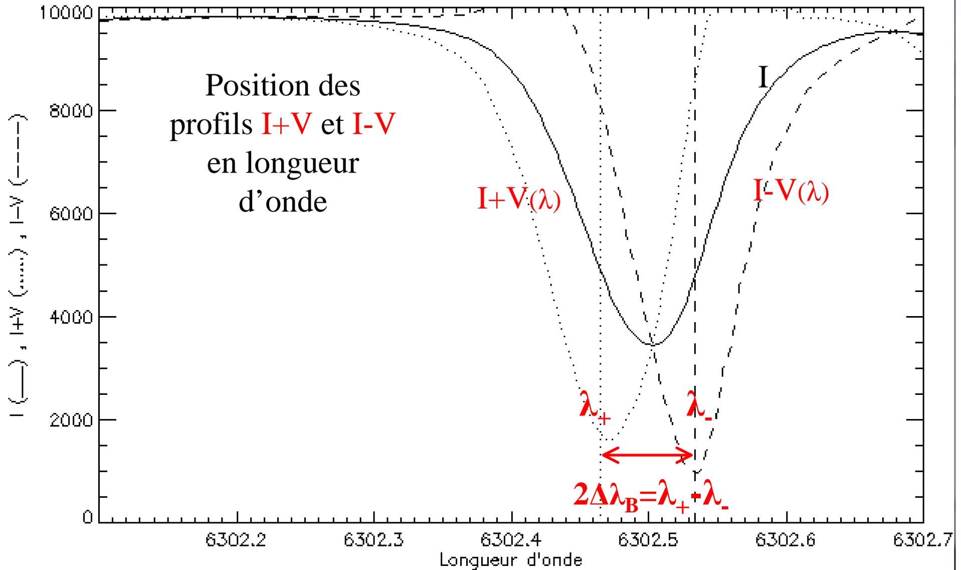
La mesure de l'écartement  $\Delta\lambda_B = [e / (4\pi m C)] \lambda^2 g^* B$  fournit le **module**  $B$  du vecteur champ magnétique
