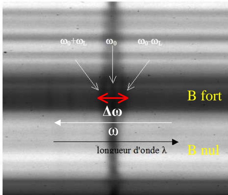
Bien souvent les mesures d'écartement sont impossibles sur les intensités  $I(\lambda)$  car trop faible donc invisible. On doit alors **isoler les deux polarisations circulaires droites et gauche**  $I+V(\lambda)$  et  $I-V(\lambda)$  avec un polarimètre pour faire cette mesure. Exemple de la raie  $H\alpha$ , effet Zeeman invisible sur  $I(\lambda)$  mais visible sur  $V/I(\lambda)$  →
