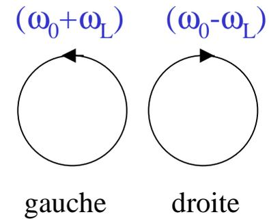
Ces deux vibrations décrivent un cercle dans le plan perpendiculaire au champ magnétique. Elles sont polarisées circulairement gauche et droite, selon la vitesse angulaire  $(\omega_0 \pm \omega_L)$
