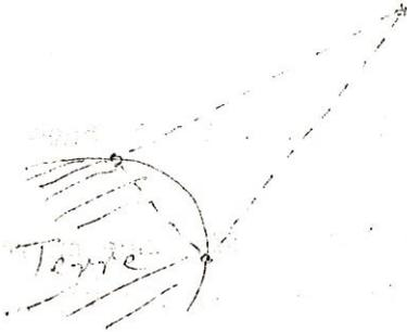
La distance d'un objet proche de la Terre a initialement été déterminée par une méthode classique de triangulation : si l'on repère simultanément la direction de l'objet observé de deux points très éloignés, on calcule directement sa distance à la Terre. Cette méthode s'adapte très bien à la lune, assez bien à Vénus, à Mars et au planétoïde Eros.; elle est trop imprécise pour des objets lointains.
