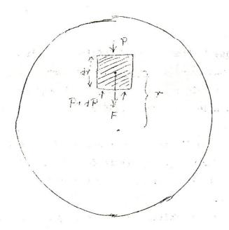
Considérons les forces exercées sur un petit cylindre élémentaire. Ce cas est identique au problème de l'équilibre mécanique de la photosphère, l'équation d'équilibre hydrostatique s'écrit:
