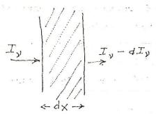
Considérons un élément d'un milieu d'épaisseur dX et de section unité. Soit I, un flux de rayonnement incident ; le flux qui sort de l'élément est I y - dIy . La perte de I y est proportionnelle à l'épaisseur
