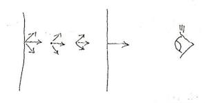
Considérons maintenant un milieu semitransparent, <u>émetteur</u> de rayonnement par exemple (un milieu incandescent). Le flux observé à l'extérieur est celui provenant de chaque profondeur du milieu et intégré sur la ligne de visée.
