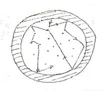
Considérons une enceinte fermée, dont l'intérieur est parfaitement réfléchissant. On "met" à l'intérieur de la pous sière et du rayonnement; la poussière peut absorber le rayonnement et le réémettre à d'autres longueurs d'onde.
