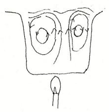
du Soleil. Cette configuration est alors analogue au cas d'un fluide fortement chauffé dans sa partie inférieure. La matière chaude située en bas est plus légère que la matière au-dessus, la situation n'est donc pas stable. Des régions chaudes se "détachent", "montent" à la surface, se refroiddssent et redescendent.
