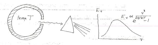
La distribution énergétique du rayonnement émis peut être étudiée à l'aide d'un système dispersif : comme la forme de la distribution est une fonction de T, on peut définir et mesurer la température à l'intérieur de l'enceinte sans y mettre un thermomètre.
